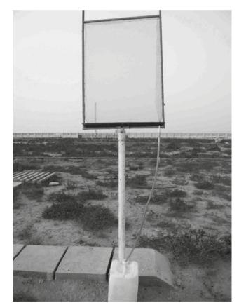
Fig. 3. Picture from designed screen collector. Fig. 3. Foto dello schermo collettore progettato.
