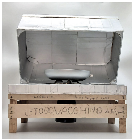
Fig. 5. Forno per cucinare, costruito dai detenuti con una cassetta di legno della frutta rivestita con il tetrapak ricavato dai cartoni del latte e dei succhi di frutta.
