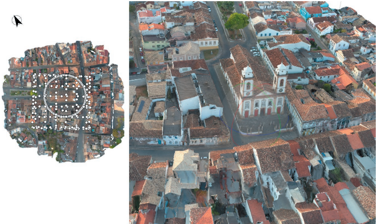
Fig. 6. Brasileiro, Vanessa. Araújo, Luiza. Dangelo, André. Pontos de captura de foto pelo drone e “nuvem de pontos” gerada. São João del Rei. 2020. Autoria própria.
