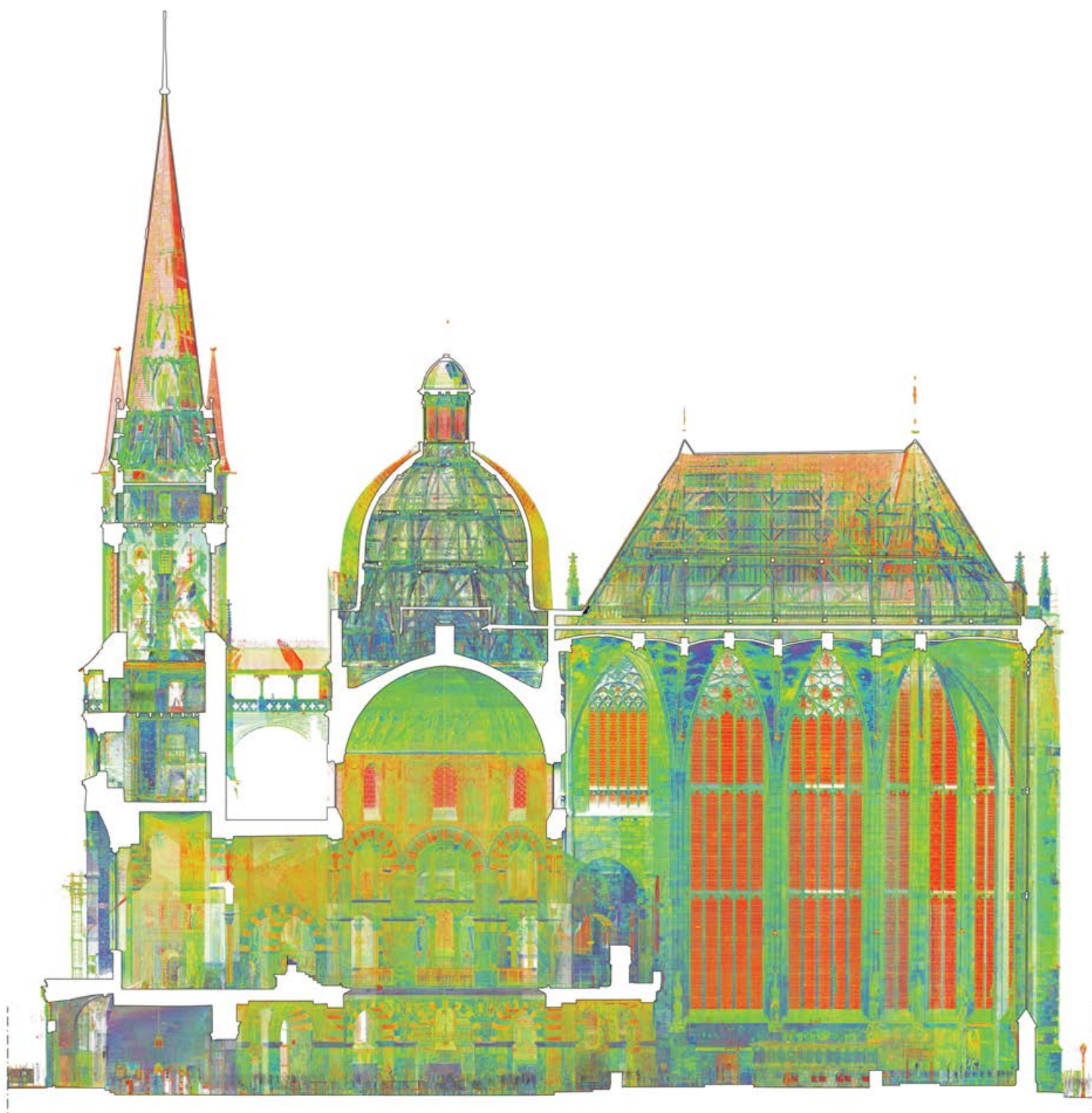
2 | Cattedrale di Aachen. Sezione longitudinale con sovrapposizione della nuvola di punti, i cui valori di riflettanza sono rappresentati tramite mappatura cromatica.
