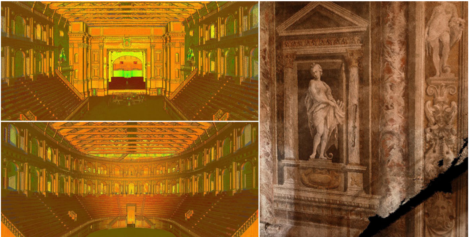
3 | La nuvola di punti frutto del rilievo laser scanner (a sinistra); la nuvola di punti frutto del rilievo fotogrammetrico (a destra su concessione del Ministero della Cultura – Complesso Monumentale della Pilotta – Teatro Farnese).
