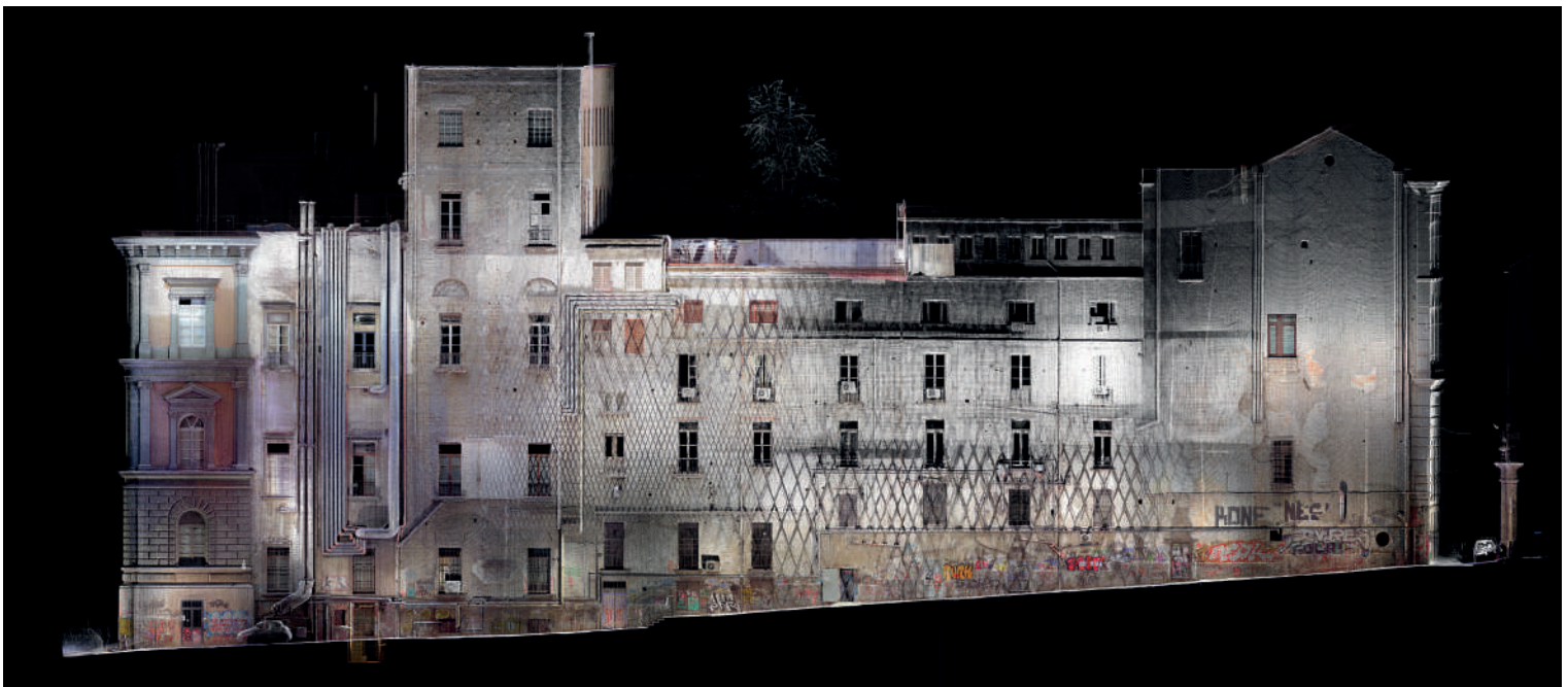
7 | Napoli, ortoproiezione dalla nuvola di punti TLS del fronte su via Mezzocannone 8, ex Convento di Donnaròmita.
