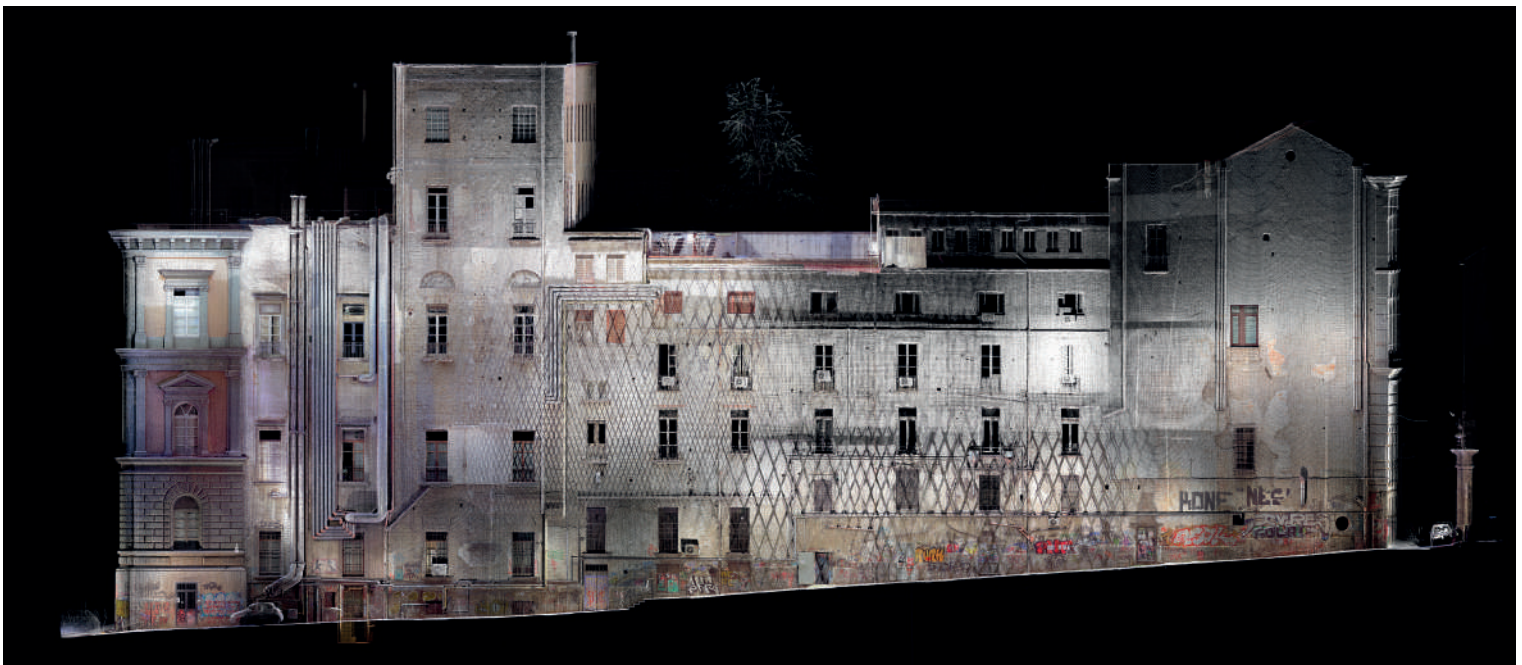
7 | Napoli, ortoproiezione dalla nuvola di punti TLS del fronte su via Mezzocannone 8, ex Convento di Donnaròmita.
