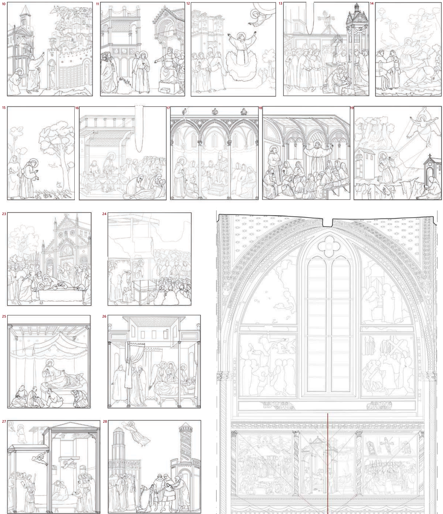
2 | Sezione longitudinale a fil di ferro di una delle campate della navata della Basilica Superiore di Assisi, con evidenziazione della modalità di rappresentazione ad asse di fuga della cornice architettonica dipinta, in corrispondenza delle scene 20, 21, e 22.
